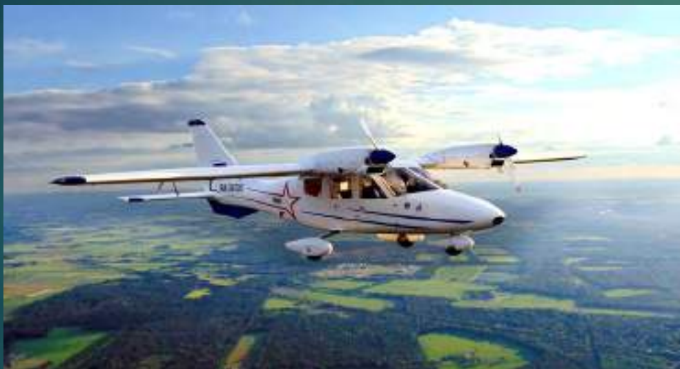
Многоцелевой четырехместный двухдвигательный самолет МАИ-411
